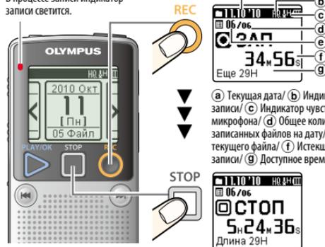
(a) Текущая дата/ (b) Индикатор режима записи/ (c) Индикатор чувствительности микрофона/ (d) Общее количество записанных файлов на дату/ (e) Номер текущего файла/ (f) Истекшее время записи/ (g) Доступное время записи
